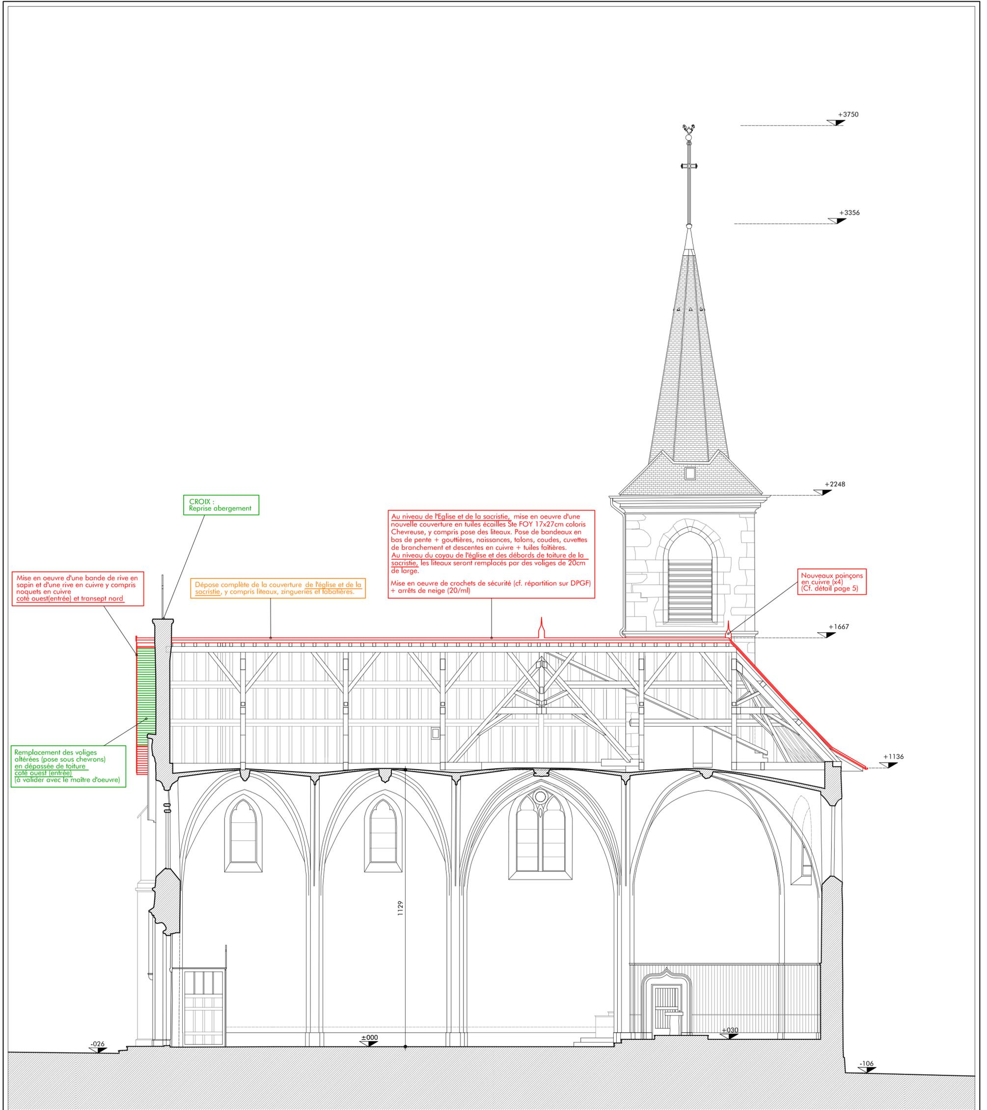
Mise en oeuvre d'une bande de rive en sapin et d'une rive en cuivre y compris noquets en cuivre coté ouest (entrée) et transept nord
